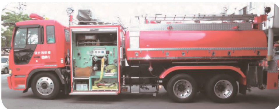
水そうつきポンプ車
