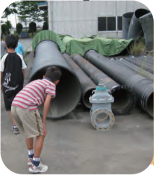
送水管の実物 送水管を通じて、寺谷浄水場から各家庭に水が送られています。
